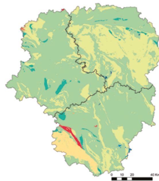
Conductivité thermique moyenne (W/m/K) sur 200 m de profondeur Représentation par mailles 250 x 250 m
